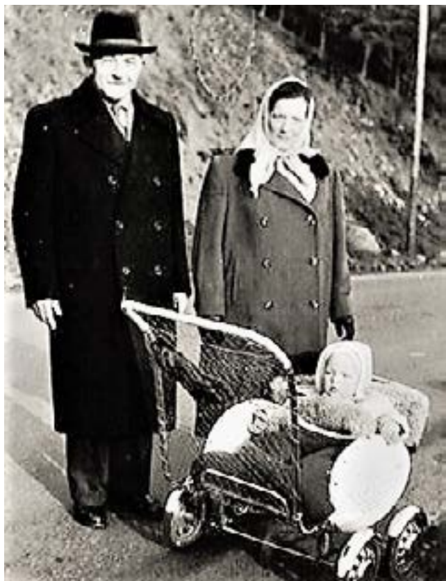
Foto 2: Rodina na výletě, kočárek typu „Hiko“ - s korbou i střechou z pedigu, chromovým nízkým rourovým podvozkem a chromovými prohnutými blatníky a typickým šesti pružinovým pérováním, r. 1963
